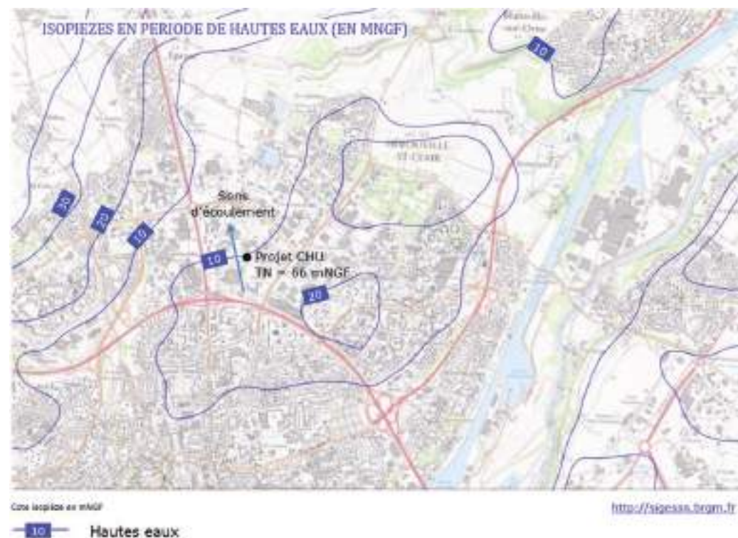
Isopièzes de la nappe du calcaire du Bathonien dans le Calvados en hautes eaux - Sources: SIGES SN BRGM Atlas 2007; SOGETI
