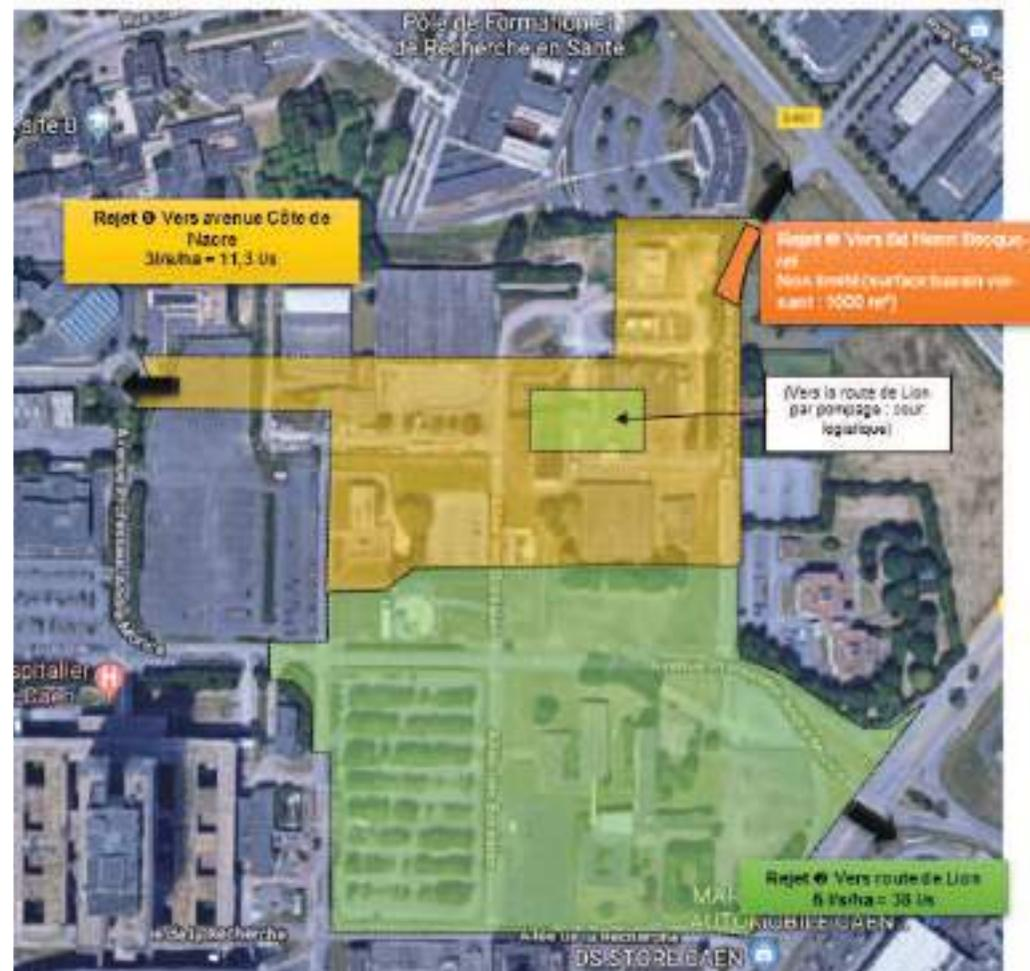
(\*) Remarque : le raccordement du ring sur le rond-point « Rousselot » interrompt un réseau d'évacuation des eaux pluviales (présumé) de l'aire de stationnement actuelle nord, qui les transfère vers le bassin d'infiltration situé à proximité de la résidence étudiante « Nemea Stanofrd ». Il est prévu la reprise de ce réseau, qui passera sous la structure du ring, pour conserver la collecte vers le bassin d'infiltration.
