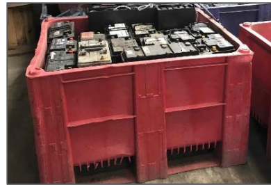
Stockage de transit des batteries en bacs étanches (sous bâtiment d'exploitation)
