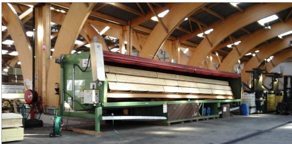
Photographie 1 : Vue de la cabine d'aspersion ouverte
