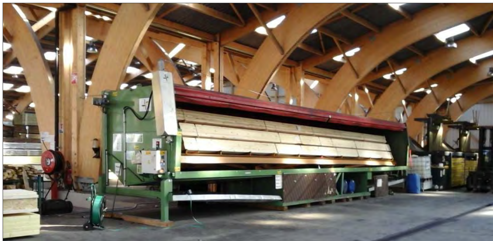
Photographie 1 : Vue de la cabine d'aspersion ouverte
