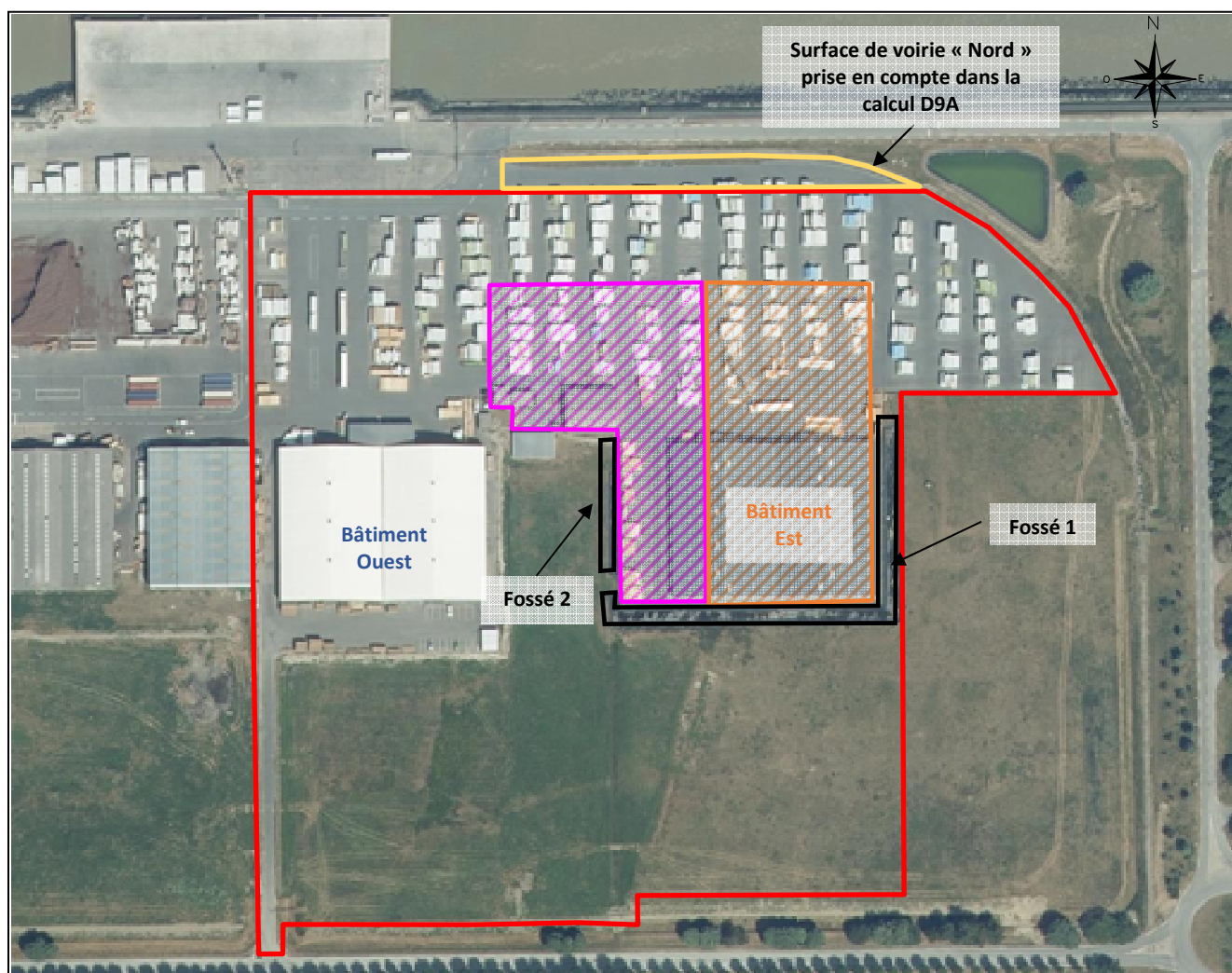
Figure 6 : Vue aérienne du site avec représentation des zones où les eaux d'extinction sont actuellement collectées
