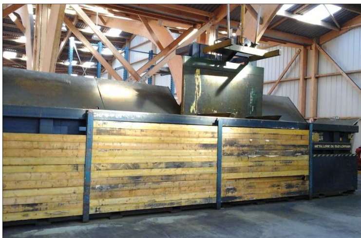
Photographie 6 : Vue du bac de trempage
