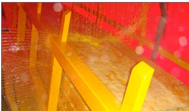
Photographie 2 : Vue d'un lot de bois en cours de traitement par aspersion
