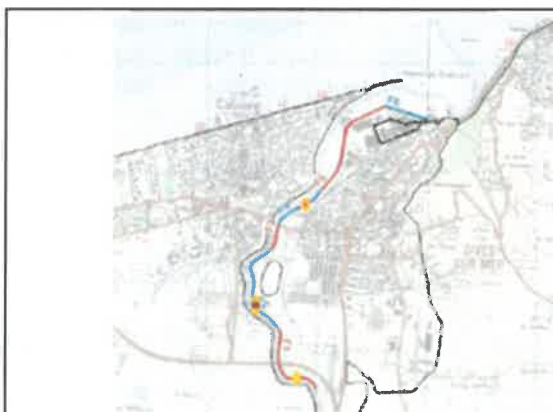
Figure 2-2: Localisation des brèches pour chacun des scénarios envisagés (figure p37 de l'étude de danger, ARTELIA & SCE, 2013)
