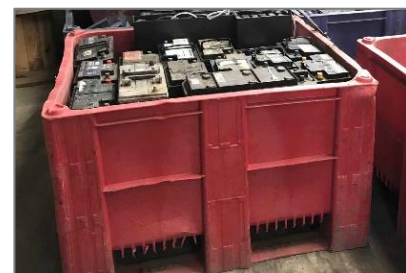
Batteries stockées en bacs étanches
