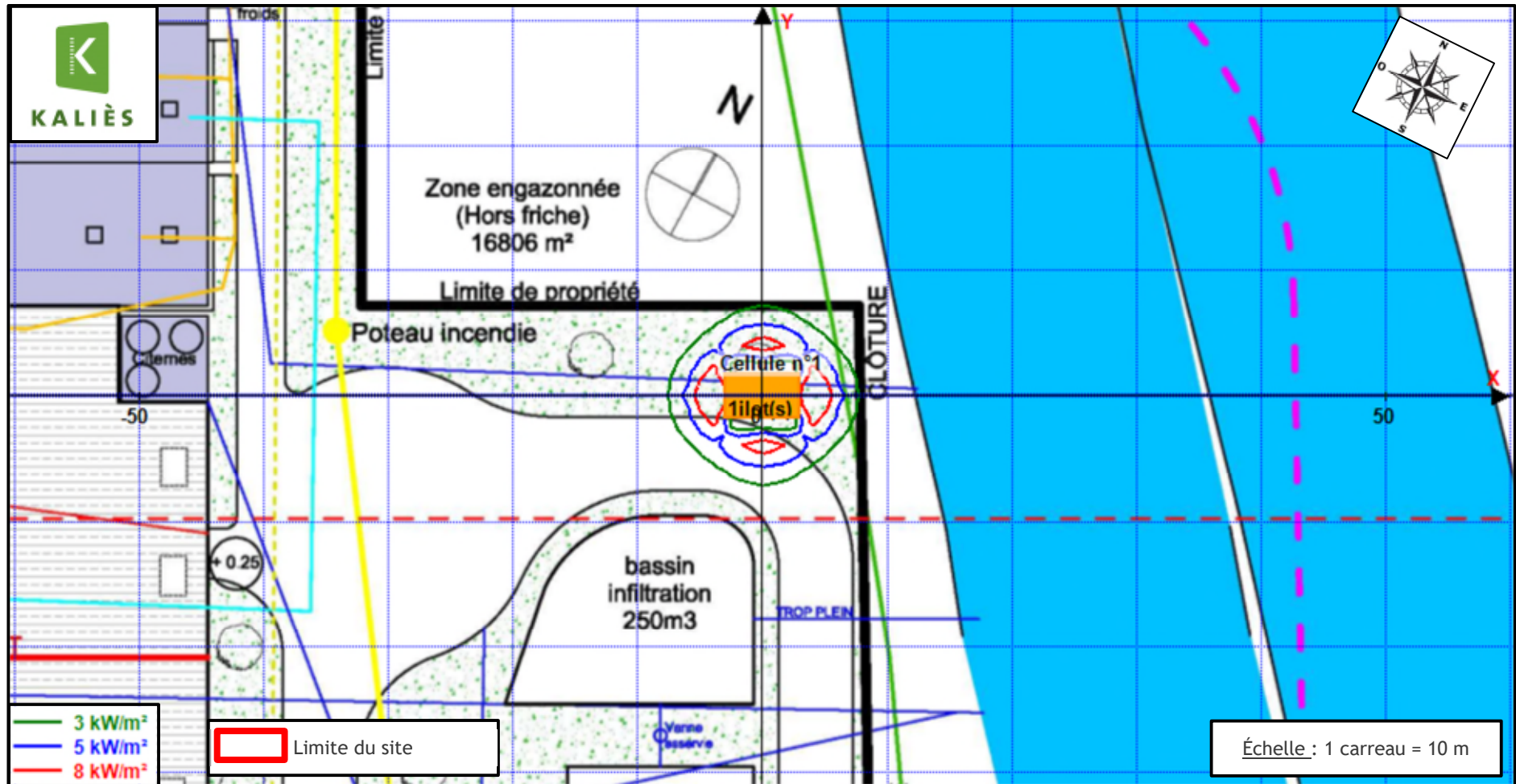
Figure 6. Modélisation d'un incendie du stockage de palettes
