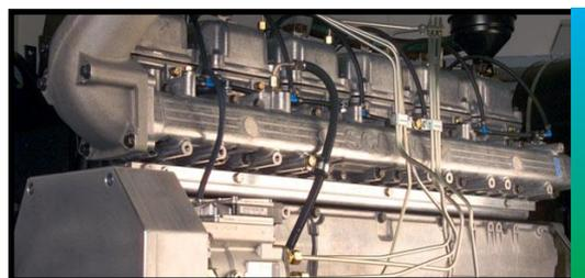
Un cogénérateur présente une puissance électrique de 250 kW (rendement électrique 43%) et une puissance thermique de 232 kW (rendement thermique 40%). Ce cogénérateur est installé dans un container spécialement conçu pour cet usage.
