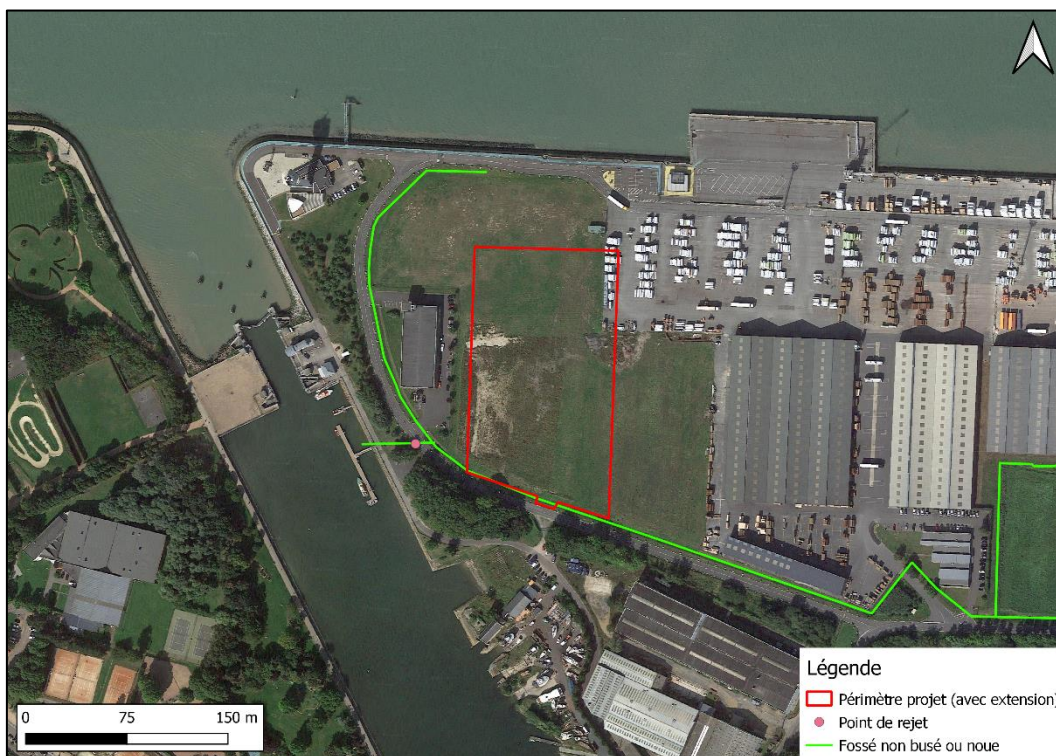
Figure 7 : Identification des ouvrages hydraulique actuellement présent dans le secteur d'étude
