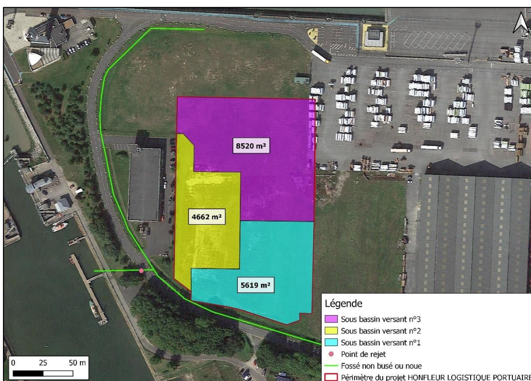
Figure 8 : Identification des sous bassins versants
