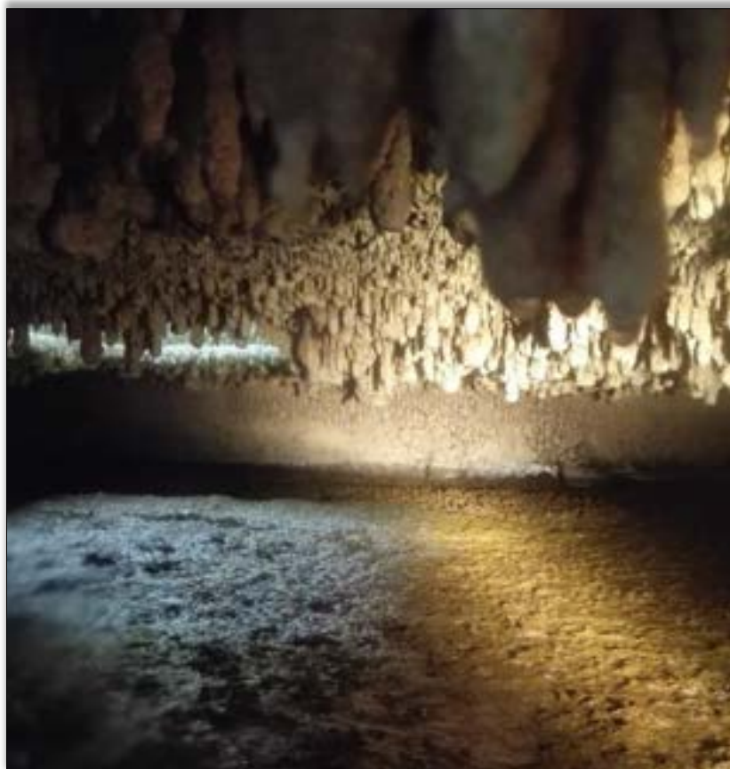
Exemple d'image: Dépôt de soufre sur le filet (partie supérieure de l'image)
