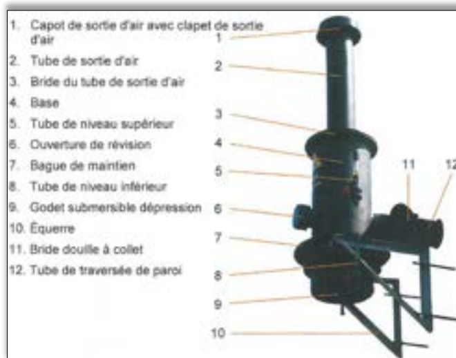
Exemple d'image: Structure du dispositif de sécurité de surpression / dépression
